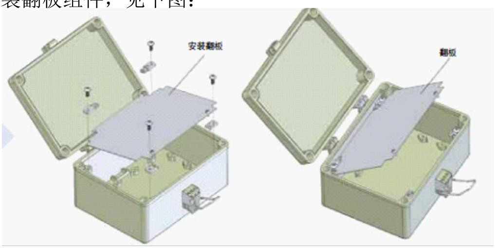
2. 将底板放在盒底下平面安装柱上,并用点动螺丝刀拧
